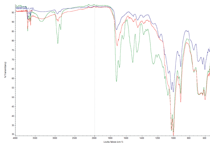
Rys. 4. Widma powłoki powierzchniowej w systemie C: linia zielona – powłoka niestarzona, linia niebieska – powłoka starzona w naturalnych warunkach atmosferycznych (zdjętej z mostu), linia czerwona – powłoka starzona w warunkach laboratoryjnych (1000 h w komorze UV) Fig. 4. Spectra of top coats in system C: green line – non aged coating, blue line – coating aged in natural environment (removed from the bridge), red line – coating aged in laboratory conditions (1000 h of exposure in UV chamber)
