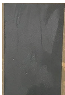
Fot. 3. Powłoka gruntu cynkowego zawierającego nieobrobiony pył Zn + nieobrobione płatki Zn + fosforan Zn po 1500 h ekspozycji w komorze solnej
