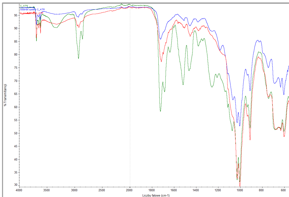
Rys. 4. Widma powłoki nawierzchniowej w systemie C: linia zielona – powłoka niestarzona, linia niebieska – powłoka starzona w naturalnych warunkach atmosferycznych (zdjętej z mostu), linia czerwona – powłoka starzona w warunkach laboratoryjnych (1000 h w komorze UV) Fig. 4. Spectra of top coats in system C: green line – non aged coating, blue line – coating aged in natural environment (removed from the bridge), red line – coating aged in laboratory conditions (1000 h of exposure in UV chamber)
